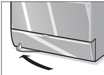
Поверните рычаг вниз с передней стороны машины справа налево. В результате этого она окажется стоящей на роликах.
