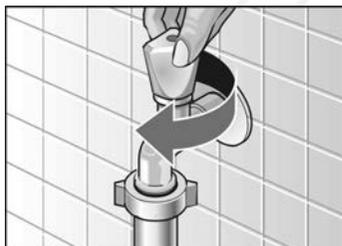
Закройте водопроводный кран. (В случае со стиральными машинами, оснащенными системой «Aqua-Stop», это следует делать только, если Вы отлучаетесь на долгое время).
